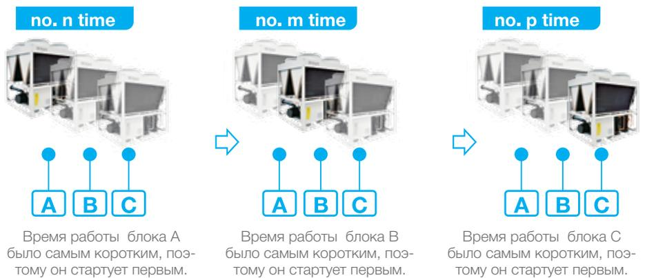
Если ведущее устройство выходит из строя, система останавливается. Когда ведущее устройство выходит из строя, любой из ведомых может быть установлен как основной блок вручную. Если ведомое устройство выходит из строя, это устройство остановится, но другие продолжают работать.
